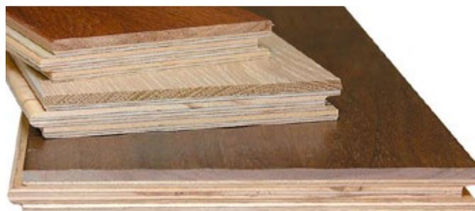
Le plancher d'ingénierie est composé de lames de bois véritable collées sur un substrat de nature différente (contreplaqué, HDF, bois résineux ou autre). Le volume de bois franc véritable étant moins important, sa réaction à la température et l'humidité est aussi diminuée. Contrairement à certaines
