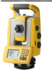
**La station totale ou le tachéomètre** est un outil de mesure à distance pour relever certains points bien précis. Elle crée une grille virtuelle et peut être utilisée pour définir les déplacements du parement par rapport à la verticale. En d'autres mots elle peut détecter des ventres de bœufs et d'autres déplacements de la pierre ou de la brique.
